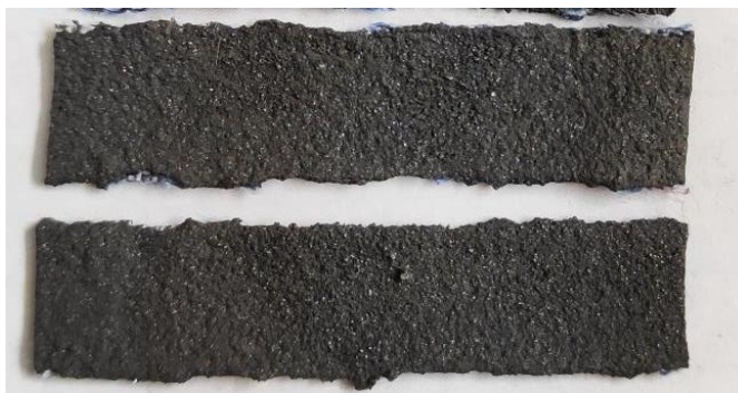
Рисунок 1 – Приклад гнучкої електродної стрічки
