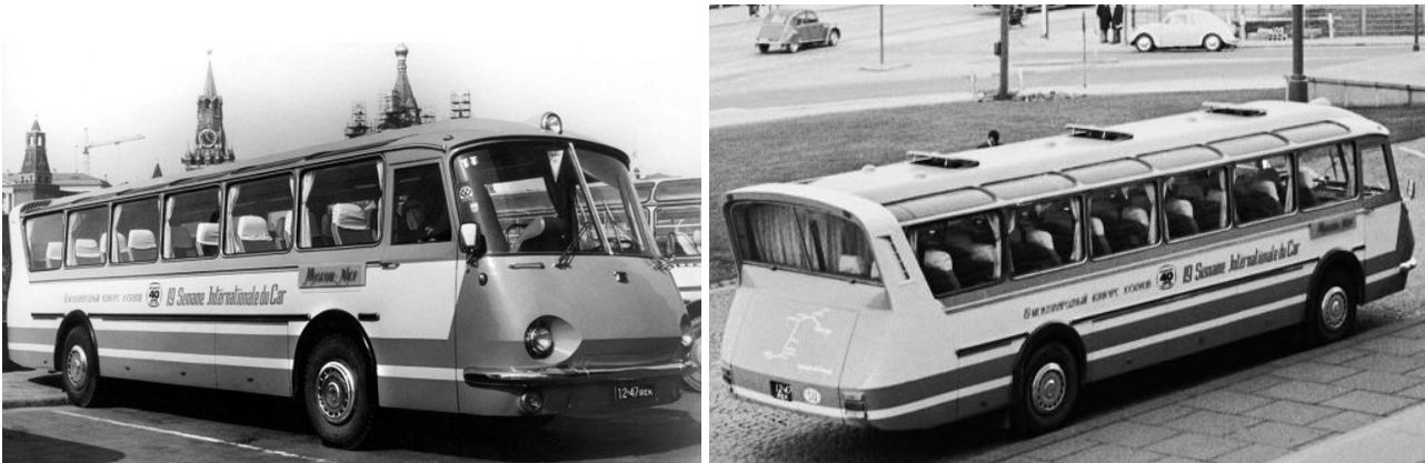
Рис. 2. Експериментальний зразок міжміського автобуса підвищеної комфортабельності моделі "Україна-67": а – на Манежній площі у Москві перед дальнім маршрутом у Францію на XVIII Міжнародний автосалон у м. Ніцца; б – оригінальний екстер'єр задньої частини та даху кузова
