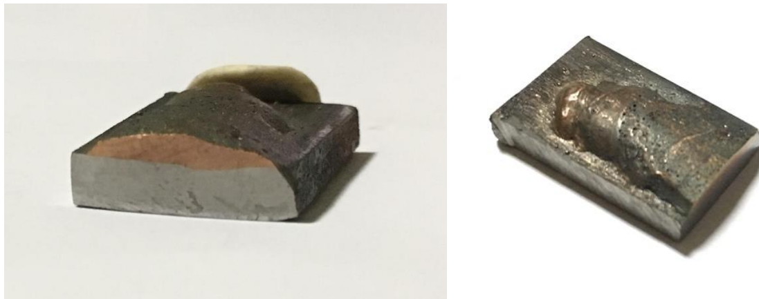
Рисунок 1 – Зразки наплавлені автоматичним способом в середовищі аргону
