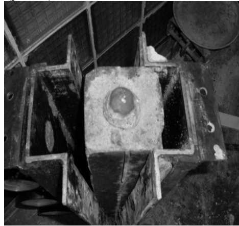
Рисунок 3 – Розпалублення форми після витримки зразка у віці 28 діб
