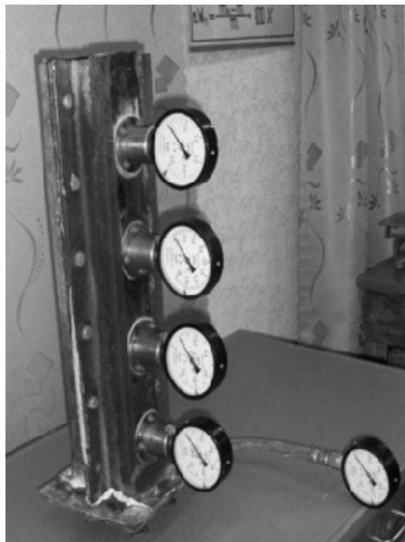
Рисунок 1 – Загальний вид установки для вимірювання фізико-механічних характеристик бетонної суміші, що ущільнюється
