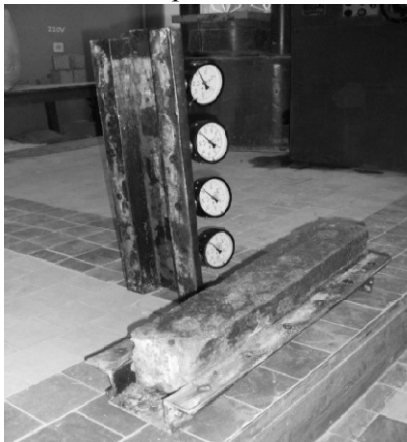
Рисунок 3 – Розпалублення форми після витримки зразка у віці 28 діб
