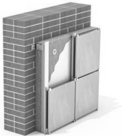
Рисунок 3 – Конструкція навісного вентиляованого фасаду
