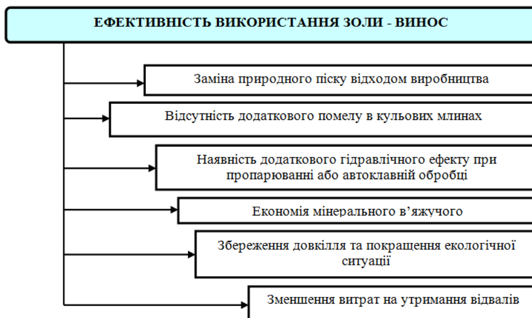
Рис. 2. Основні позитивні фактори використання золи-виносу в технології виробництва ніздрюватих бетонів
