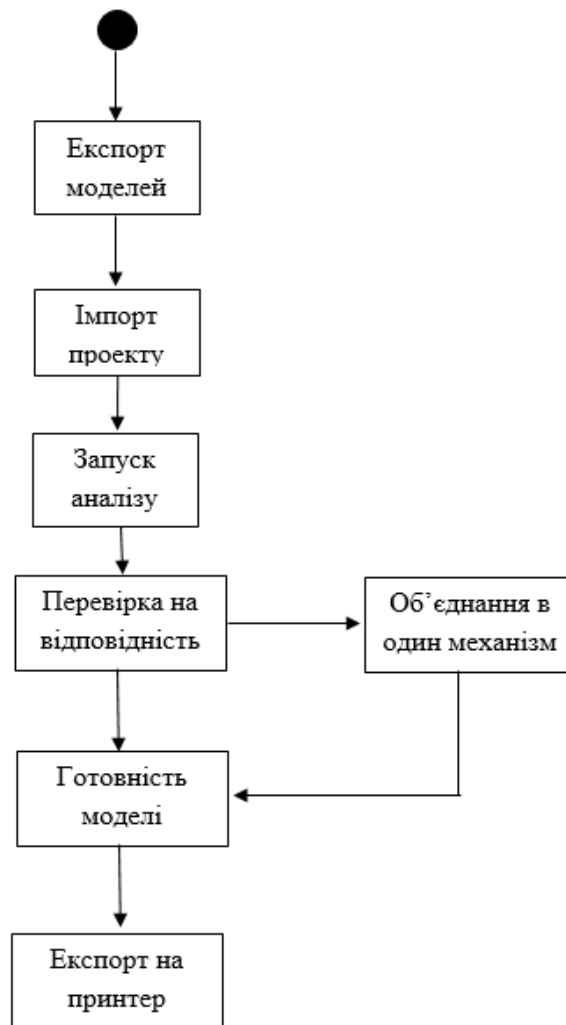
Рисунок 1 – Діаграма алгоритму аналізу 3d-моделі на готовність до друку
