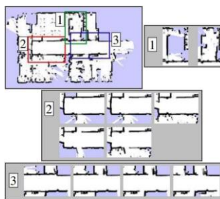
Рис. 2. Мапа з клаптиків, що представляє різні конфігурації, засвоєні для окремих під-мап в типовому офісному середовищі
