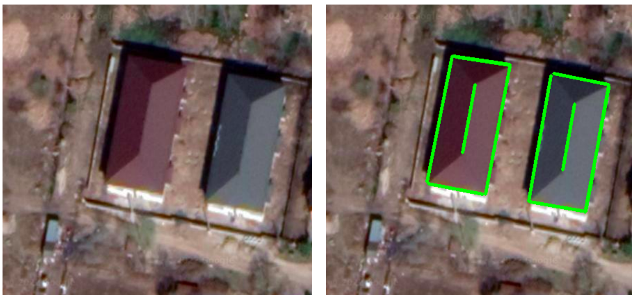
Рисунок 5 - Результат роботи алгоритму для знаходження контурів країв та гребінця даху
