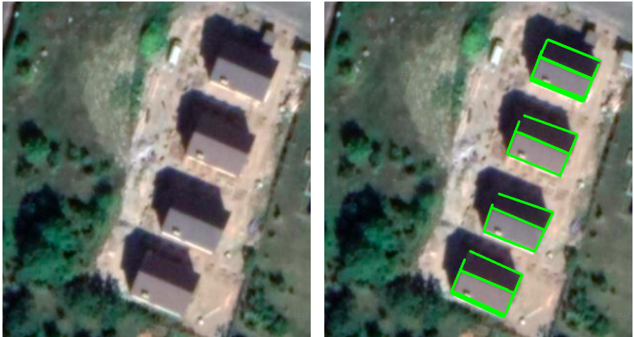
Рисунок 6 - Результат роботи алгоритму для знаходження контурів країв та гребіння даху
