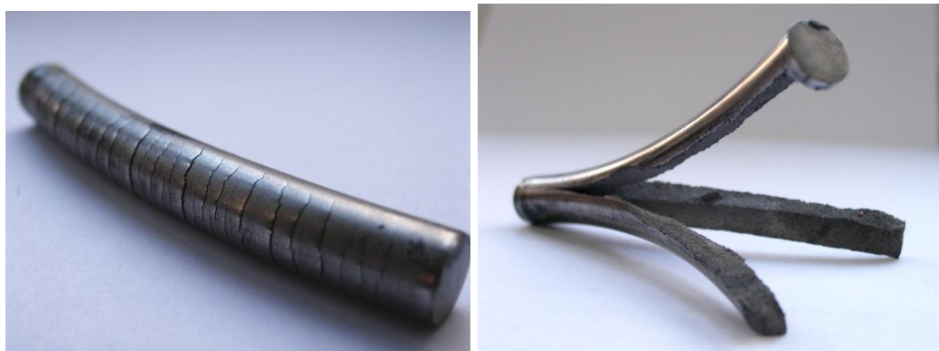
Рис. 2. Різновиди браку сплаву W-Ni-Fe при різних значеннях кута нахилу матриці
