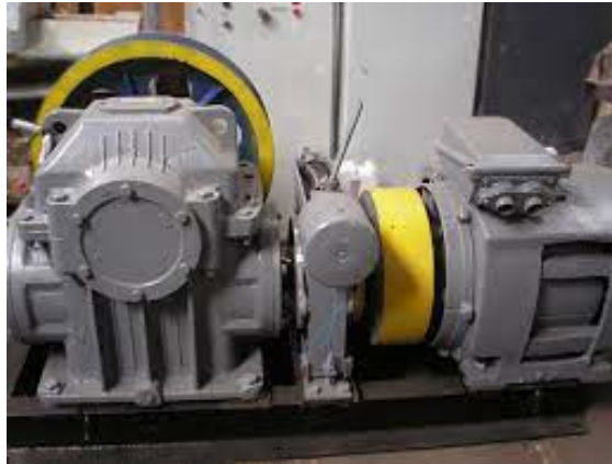
Рис. 1. Підйомний механізм ліфта. Лебідка барабанного типу
