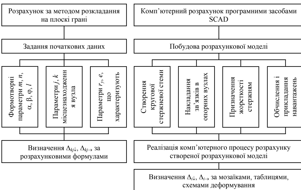
Рис. 1. Структурно-логічна схема реалізації процесу обчислення переміщень вузлів металевого циліндричного стержневого покриття, визначених за методом розкладання на плоскі грані і шляхом комп'ютерного розрахунку програмними засобами SCAD
