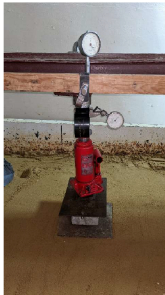
Рис. 6 – Модель фундаменту, підсиленого банкетом зверху, перед випробуванням
