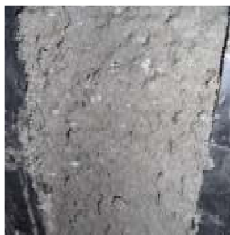
Рис. 3. Характер ущільненої структури спресованого бетону після розпалублення
