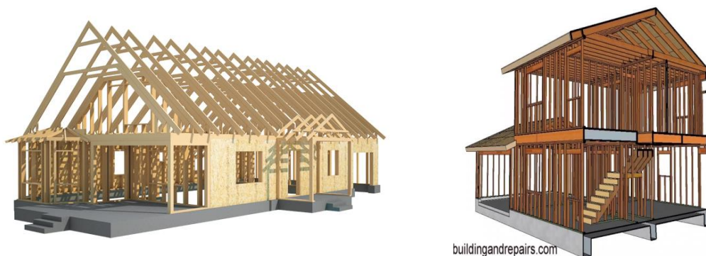
Рис. 1 Приклади дерев'яних каркасів житлових будинків.
