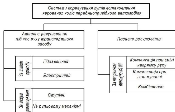
Рис. 1. Системи корегування кутами встановлення керованих коліс
