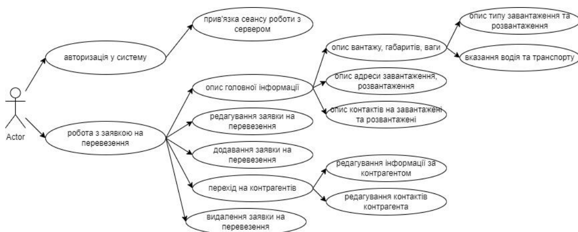
Рис. 1 – Діаграма прецедентів функціонального модуля «Заявка на перевезення»
