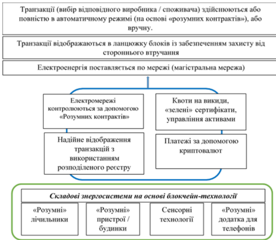
Рисунок 2- Децентралізована система енергетичних транзакцій та постачання енергії
