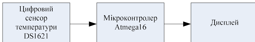
Рис. 1. Електрична схема пристрою для вимірювання температури
