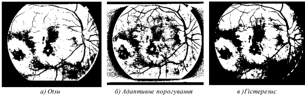
Рисунок 2 – Результат роботи порогових методів сегментації зображення очного дна (Matlab)
