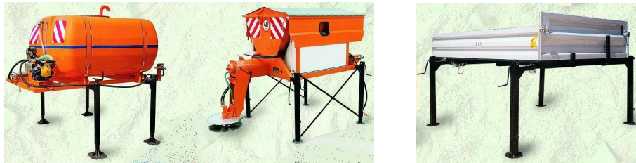
Рис. 6. Система змінних кузовів автомобілів ТТП на основі поворотних телескопічних опор на кожному кузові
