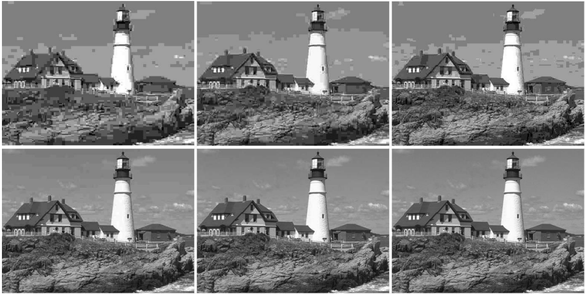
Рис. 1 – Зображення №21 з бази KODAK після компресії для різних рівнів якості VIF (рядково зліва направо: 0.11, 0.21, 0.31, 0.46, 0.68 та 0.99)
