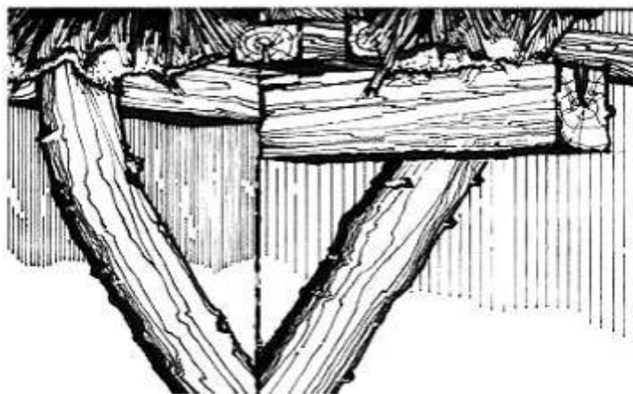
Рис. 2. Винос даху за допомогою «п'ятнарів»
