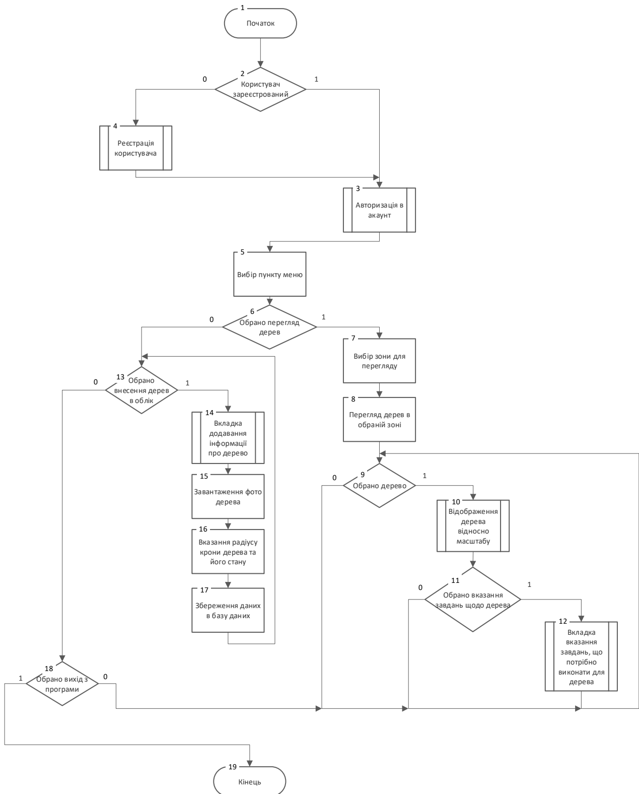
Рисунок 1 – Блок-схема алгоритму роботи автоматизованої системи моніторингу стану дерев
