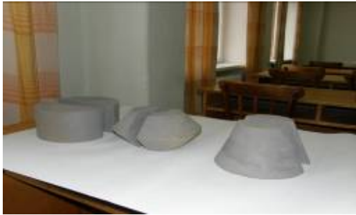
Рис. 1. Варіанти елементів збірно-монолітної палі
