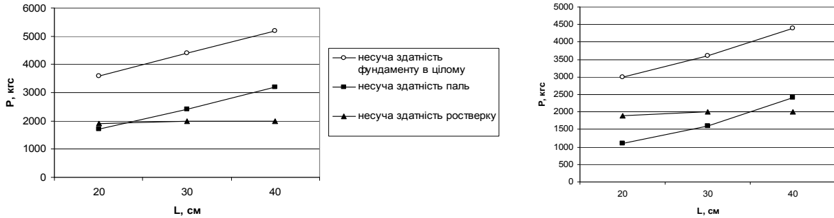
Рис. 9. Графік залежності несучої здатності фундаменту від довжини паль при кроці паль 3d (зліва) і 6d (справа)
