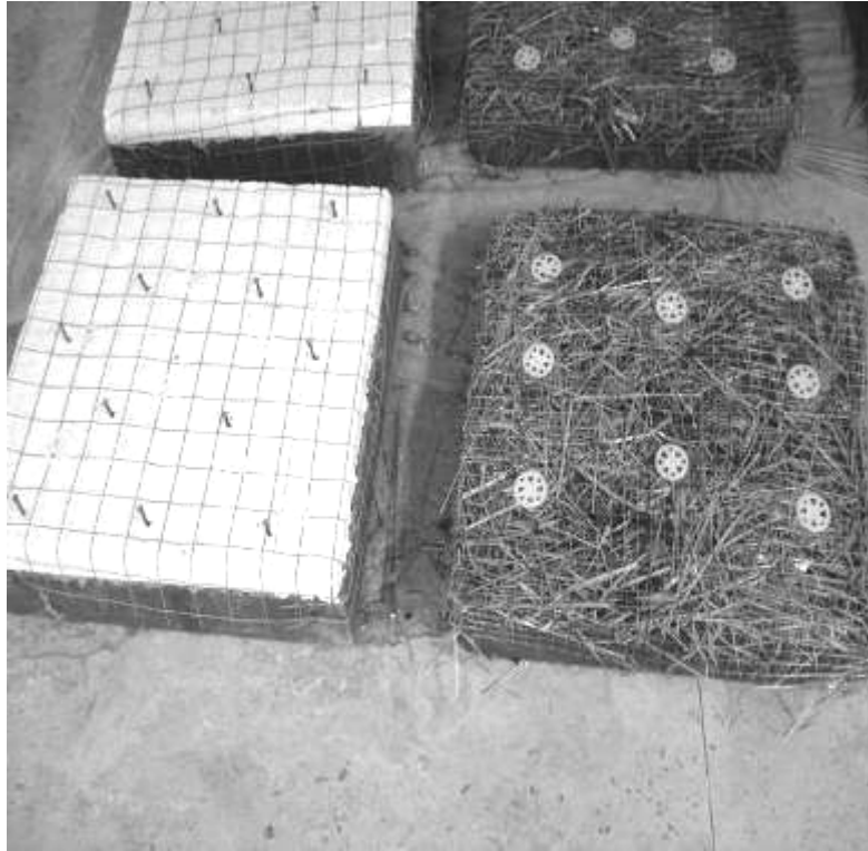
Рис. 4. Дослідні зразки із пінополістиролу і соломи підготовлені під торкретування
