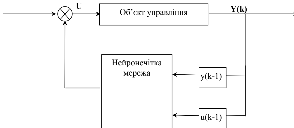
Рис. 4. Схема управління процесом тепловологісної обробки у загальному вигляді
