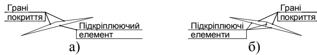
Рис. 2. Фрагменти поперечного перерізу покриття, підкріпленого: а – одним елементом; б – двома елементами з підпіркою
