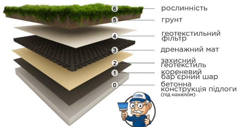
Рис. 3. Модульні системи зелених дахів
