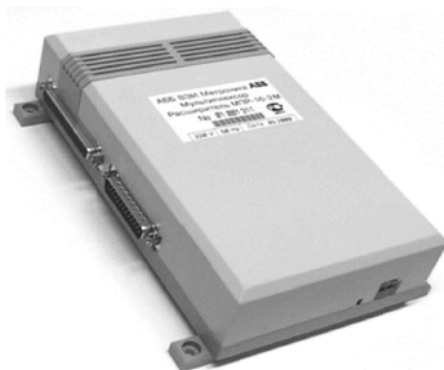
Рисунок 7.5. – Загальний вид мультиплексора-розширювача МПР-16-2(М)
