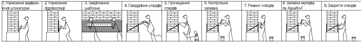
Рис. 5. Технологічна послідовність влаштування горизонтальних гідроізоляцій (гравітаційно)
