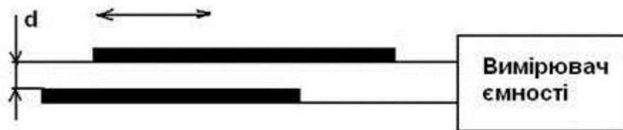
Рисунок 4.5,а – Ємнісний датчик, що реагує на відстань між пластинами
