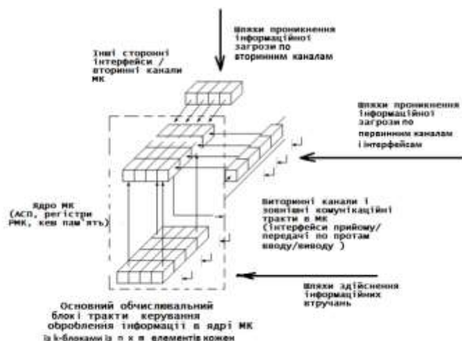
Рисунок 4 – Умовна ілюстративна схема інформаційних впливів (впровадження кіберзагроз) по основним і вторинним каналам у багатомодульному середовищі ІС МК
