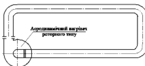
Рис. 4. Схема установки із аеродинамічним нагрівачем роторного типу із замкнутою системою розподільчих каналів
