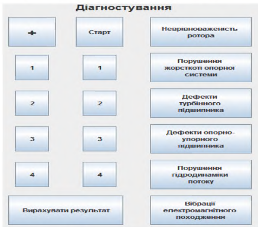
Рисунок 3.11 – Фрагмент інтерфейсу програми діагностування існуючих дефектів гідроагрегату
