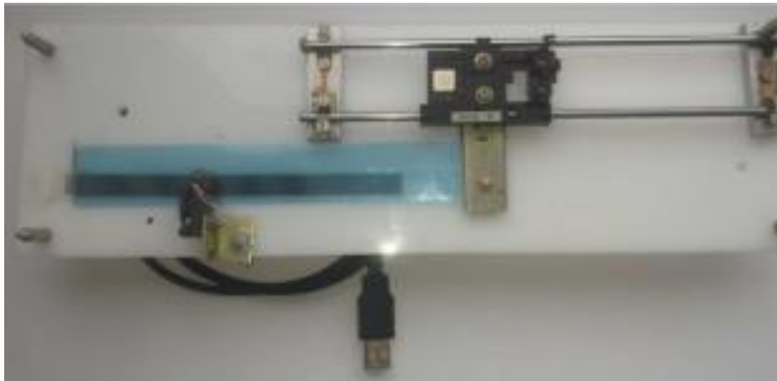
Рисунок 2 – Загальний вигляд діючої моделі датчика лінійних переміщень на муаровому ефекті
