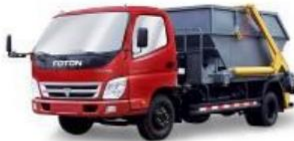
Рисунок 3 – Контейнерний смітєвоз із гачковим автоматом підйому для контейнерів об'ємом 8 м 3 для збирання великогабаритних відходів
