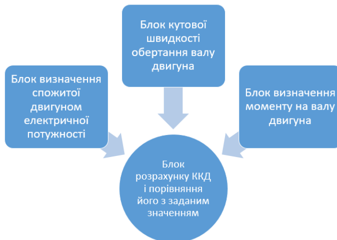
Рисунок 2 – Спрощена функціональна схема процесу вимірювання ККД ТД
