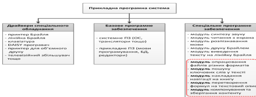
Рисунок 1 - Структурна схема прикладної системи опрацювання українських технічних текстів для людей з вадами зору
