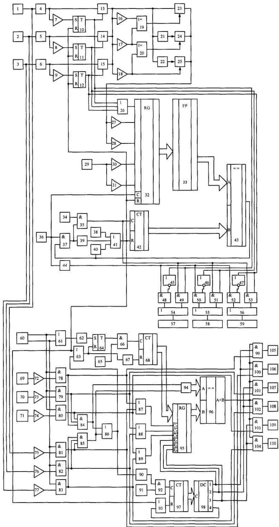
Корисна модель належить до області електротехніки і може бути використана для вимірювання комутаційного ресурсу повітряних високовольтних вимикачів.
