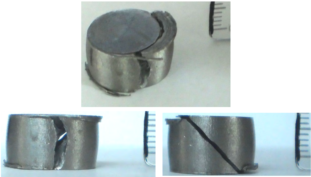
Рис. 7. Руйнування зразка із сплаву ВТ9 під час вісесиметричної осадки
