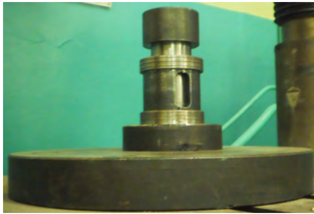
Рис. 6. Пристосування для вісесиметричної осадки на гідравлічному пресі ПММ-125
