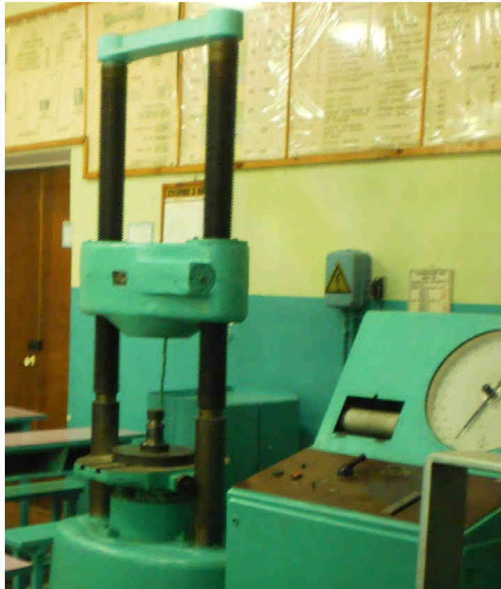
Рис. 5. Загальний вигляд гідравлічного преса ПММ-125
