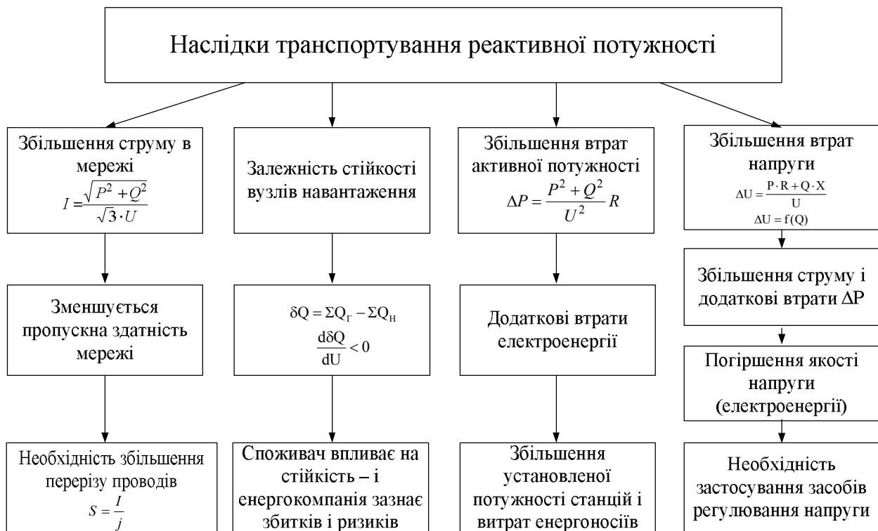
Рис. 1. Чинники впливу реактивної потужності на електричну мережу
