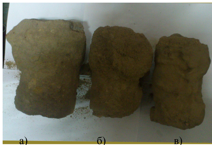
Рис. 3. Отримані експериментальні зразки: а) за частоти пульсації 10 Гц; б) за частоти пульсації 5 Гц; в) за постійного тиску ін'єктування
