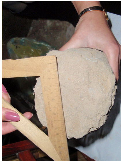
Рис. 2. Визначення радіуса розповсюдження розчину отриманого експериментального зразка за тиску нагнітання p = 0,3 \text{ кГс/см}^2 з частотою пульсації 10 Гц
