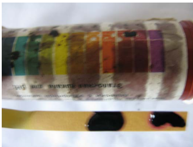
Рисунок 4.13 – Визначення рН отриманої бітумної емульсії
