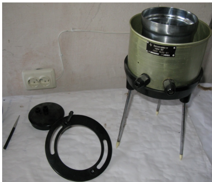
Рисунок 4.14 – Віскозиметр типу ВУ ГОСТ 1532-81 №769 1986 для випробування бітумної емульсії
