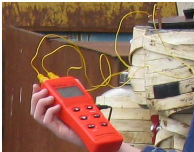
Рисунок 4.3 – Реєструвальний пристрій Meterman TMD 90 під'єднаний до експериментальної установки
