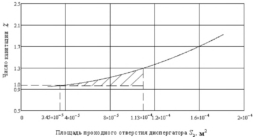
Рис. 3. Зависимость числа кавитации от площади проходного отверстия диспергатора
