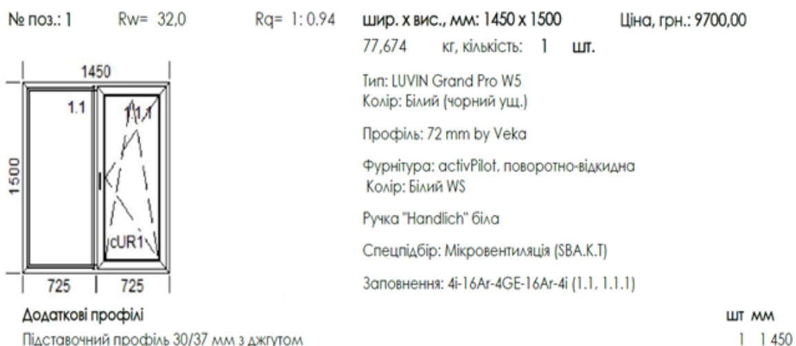
Рисунок 4.1 – Загальний вигляд та технічні характеристики базової віконної конструкції (альтернатива V1 ) [84]
