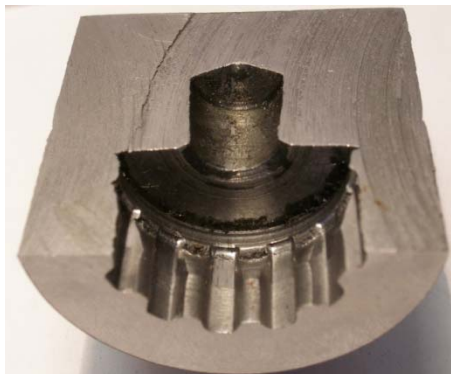
Рис. 1. Деталь із внутрішньою шліцьовою поверхнею в глухому отворі
