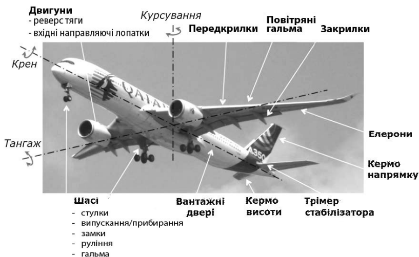
Рисунок 1 – Компоненти комерційного літака, функціонування яких потребує силового привода [1]
