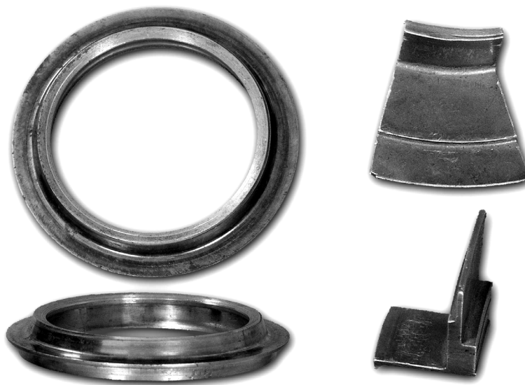
Рис. 5. Деталі, що виготовлені холодним торцевим розкочуванням циліндричним валком
