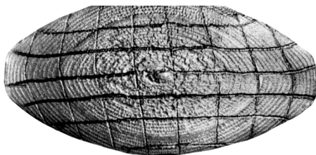
Рис. 10. Деформація координатної сітки на торці зразка після вальцювання в овальному калібрі. Зразок 3. Сплав АК6, \varnothing 50 мм, R_k/R_3 = 2,1
